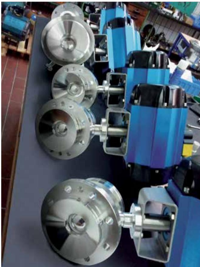
Bodenablass-Kugelhahn für die Pharmaindustrie
