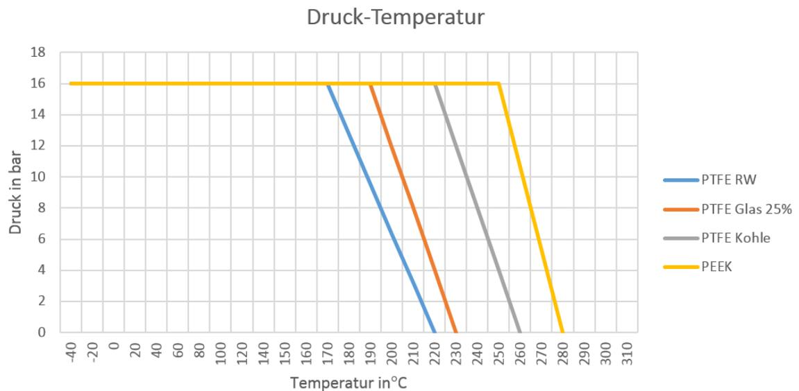
Bei Nichtbeachtung dieser Grenzwerte kommt es zur sachwidrigen, nicht bestimmungsgemäßen Verwendung des Produkts und allenfalls zu nicht vorhersehbaren Schäden oder reduzierter Lebenserwartung der Armatur.
